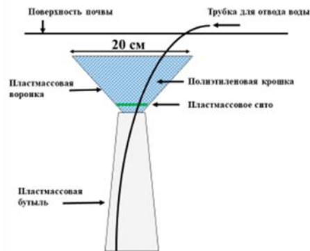
Схема гравитационного лизиметра
