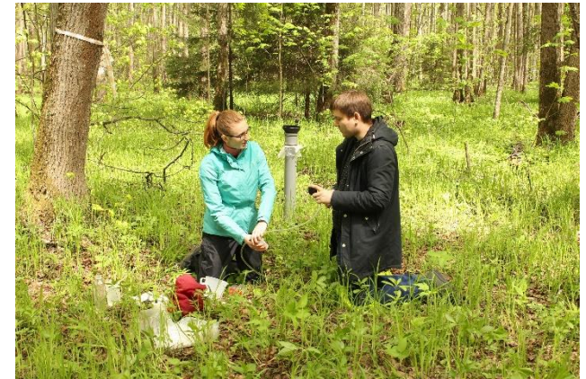
Откачка почвенных вод из гравитационного лизиметра
