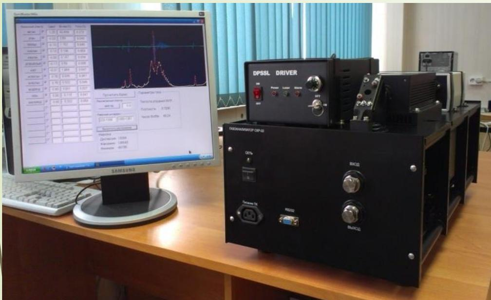
Экспериментальный образец высокочувствительного мобильного прибора для регистрации спектров комбинационного рассеяния (КР) газовых сред. Данный КР-спектрометр позволяет в оперативном режиме одновременно контролировать в атмосферном воздухе содержание всех молекулярных компонентов (включая их изотопические модификации) с пороговой чувствительностью от 50 ppb
