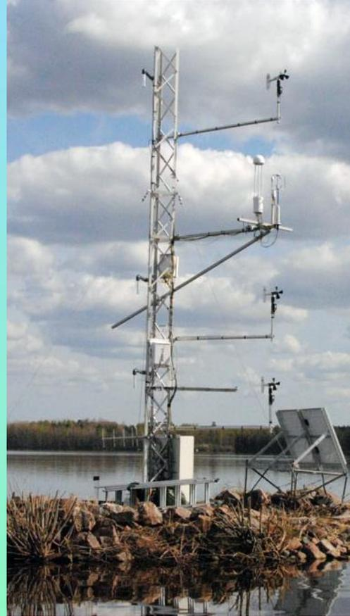
Вертикальный поток изучаемого газа ( $F$ ) может быть представлен как произведение плотности сухого воздуха ( $\rho_a$ ) на ковариацию (осредненное произведение мгновенных отклонений от средних значений) вертикальной скорости ветра ( $w$ ) и коэффициента смешивания ( $\phi$ ) изучаемого газа:
