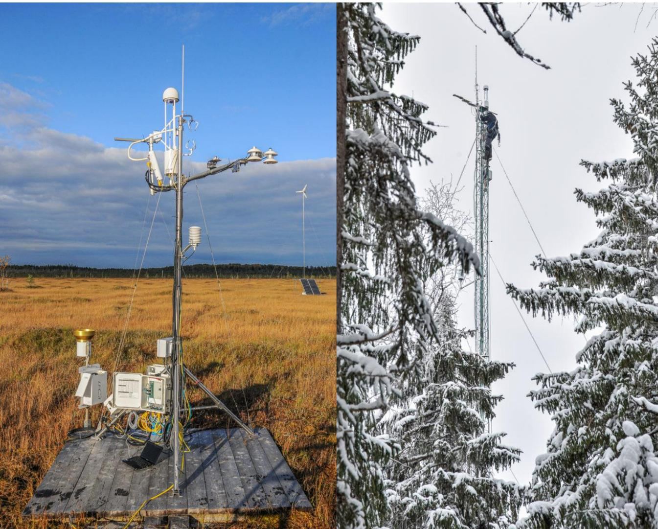
Все площадки оборудованы эколого-климатическими станциями для автоматических высокочастотных непрерывных наблюдений за экосистемными потоками парниковых газов на основе методики турбулентных пульсаций и метеорологическими величинами.
