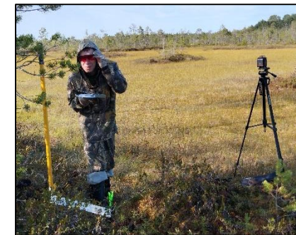
Измерение толщины слоя торфа наростшего над корневой шейкой
