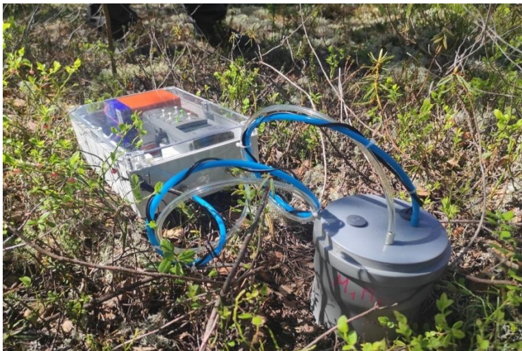
Портативный анализатор закрытого типа, на основе серийного промышленного инфракрасного сенсора VENTPro
