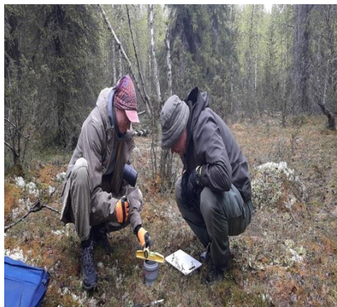
Портативный анализатор закрытого типа, на основе серийного промышленного инфракрасного сенсора VENTPro
